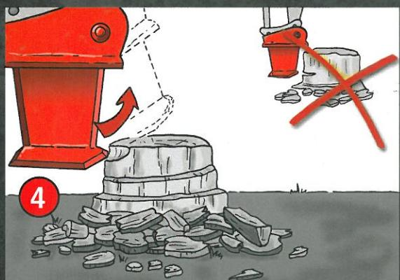
Der Wurzelstock kann kontinuierlich von einer Seite aus gerodet werden, von oben nach unten. Nicht zu tief ansetzen!
