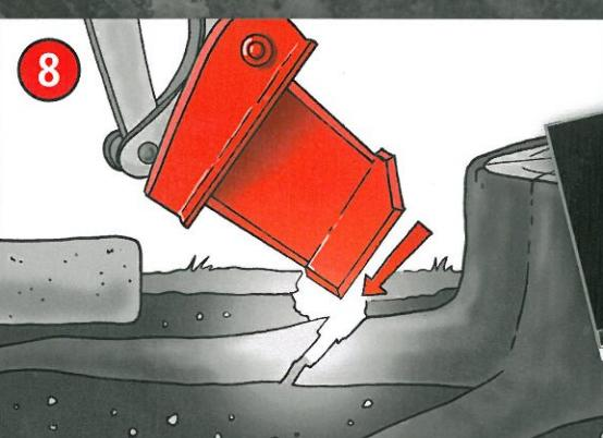
Wurzeln, die sich **UNTER** Belägen, Asphalt, etc. befinden, können punktgenau mit einer Bewegung nach unten mit den 4 Schneiden abgetrennt werden.
