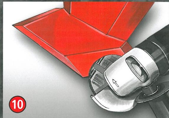
Die **Wurzelratte®** kann leicht mit einem Winkelschleifer im vorgegebenen Winkel mit der Schrupscheibe nachgeschärft werden.
