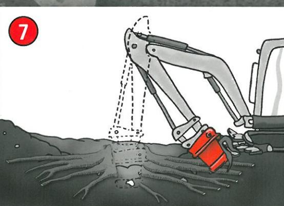
Absuchen des Standortes nach Wurzelstockresten, dabei werden Seitenwurzeln mit entfernt.
