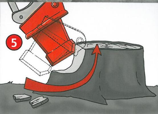
Durch die Kipp-Bewegung können auch größere Holzstücke des Baumstumpfes sowie des Wurzelanlaufes entlang der Faser aufgebrochen werden.
