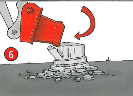
Um bei fortgeschritten der Rodung ein Abrutschen der **Wurzelratte®** zu vermeiden, setzt man diese von oben mit der hinteren Schneide auf den Wurzelstock auf, um mit einer Kipp-Bewegung nach hinten die Fasern wegzubrechen.
